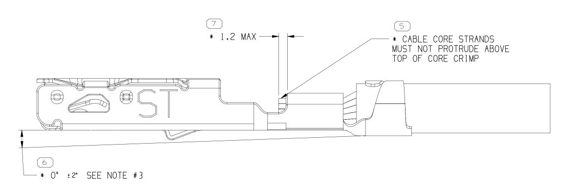
TERMINAL, CABLE ALIGNMENT & POSITION
