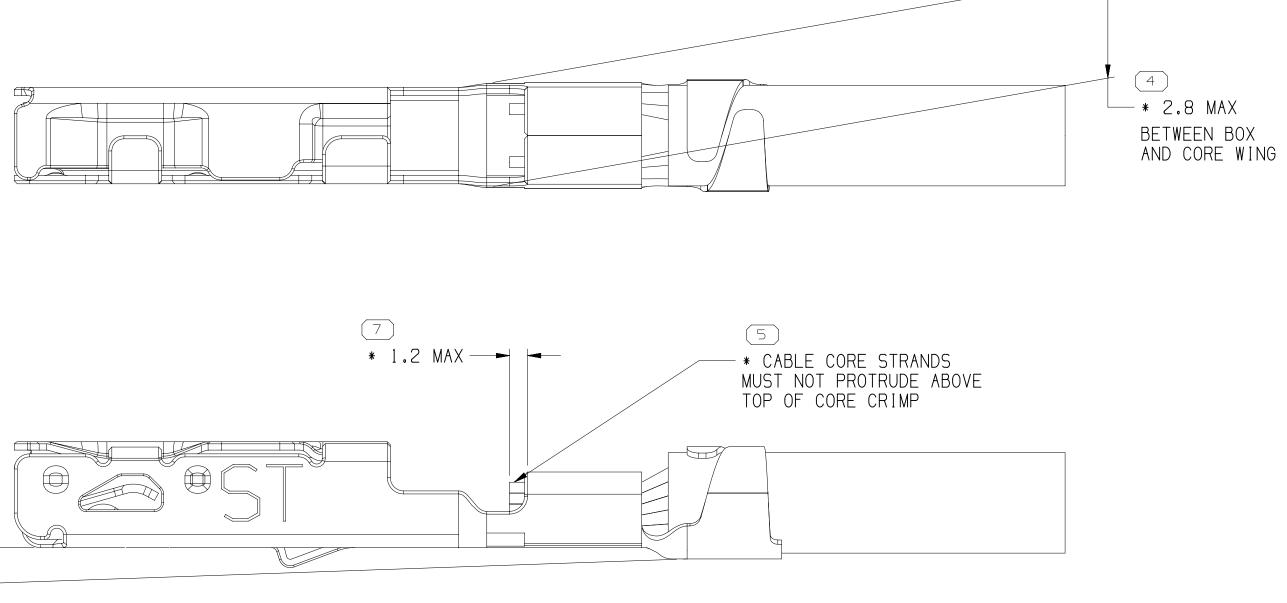
TERMINAL, CABLE ALIGNMENT & POSITION
